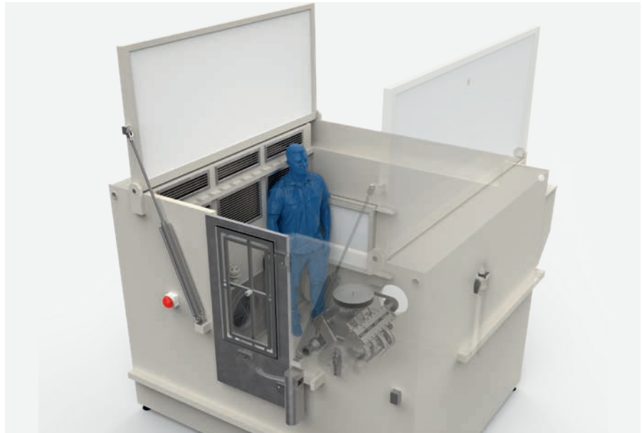
Für ein optimales Ergebnis werden die geometrisch anspruchsvollen Hubschrauber-Getriebeteile druckluftfrei abgeblasen und anschließend bei 60° C vollständig getrocknet
