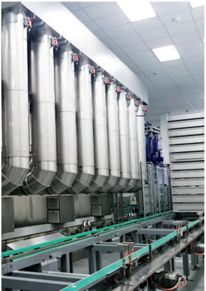
Kühl- und Trockentunnel sind den Sterilisatoren nachgeschaltet und laufen wechselseitig.
