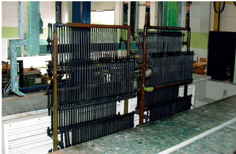
Gestell beim Einfahren in den Trocknungstrog der Verzinkungsanlage bei der Firma Comte Metallveredelung in Sulingen
