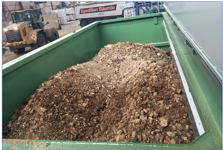
Abb. 3: Extrem trockene Luft kombiniert mit der richtigen Luftführung sorgen für eine homogene Trocknung des Schlammes. Bis zu 60 % an Gewicht und Volumen lassen sich durch die Schlamm-trocknung einsparen.
