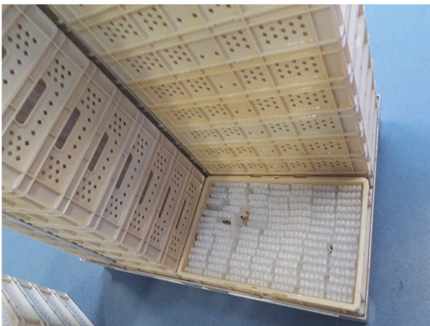
Abbildung 1: Nach der Sterilisation werden Ampullen in zu Paletten aufgestapelt Körben vollständig abgespült, bei 60 °C sicher getrocknet und anschließend auf 30 °C ± 5 °C gekühlt (Quelle aller Abbildungen: Harter).
