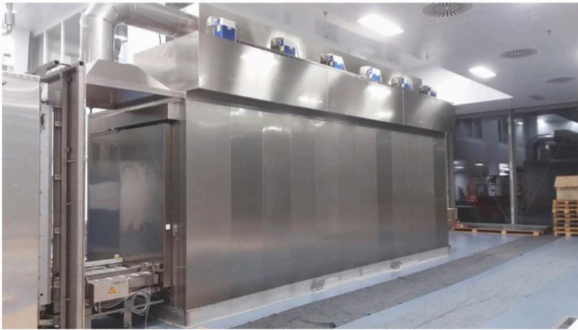
Abbildung 2: Die vollautomatische Anlage wäscht, trocknet und kühlt. Das System ist lufttechnisch geschlossenen und arbeitet äußerst energie- und CO 2 -sparend.
