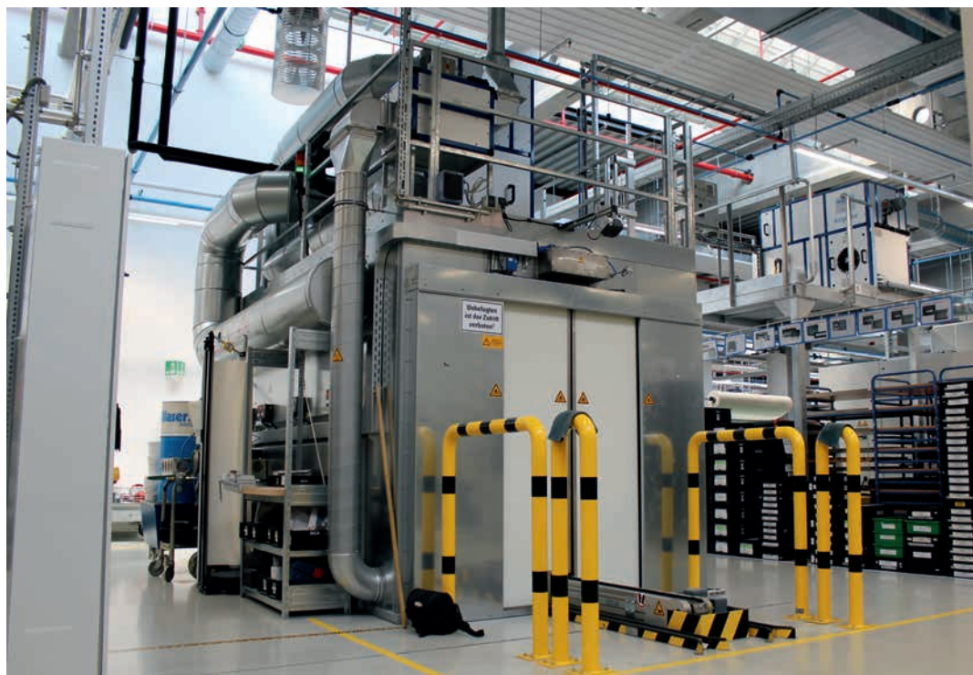
Abdunsten und Trocknen erfolgen in der „Airgenex“-Kombi-Anlage.
