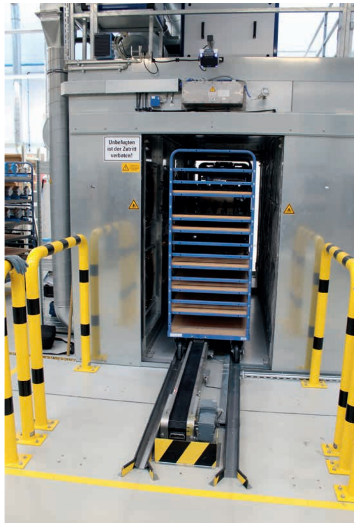
Die Hordenwagen werden in den Trockenraum gefördert.
