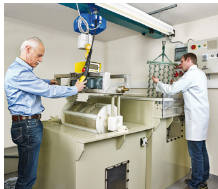
Trocknungsversuche zur Ausführung der Anlagen können im Technikum bei Harter vorgenommen werden
