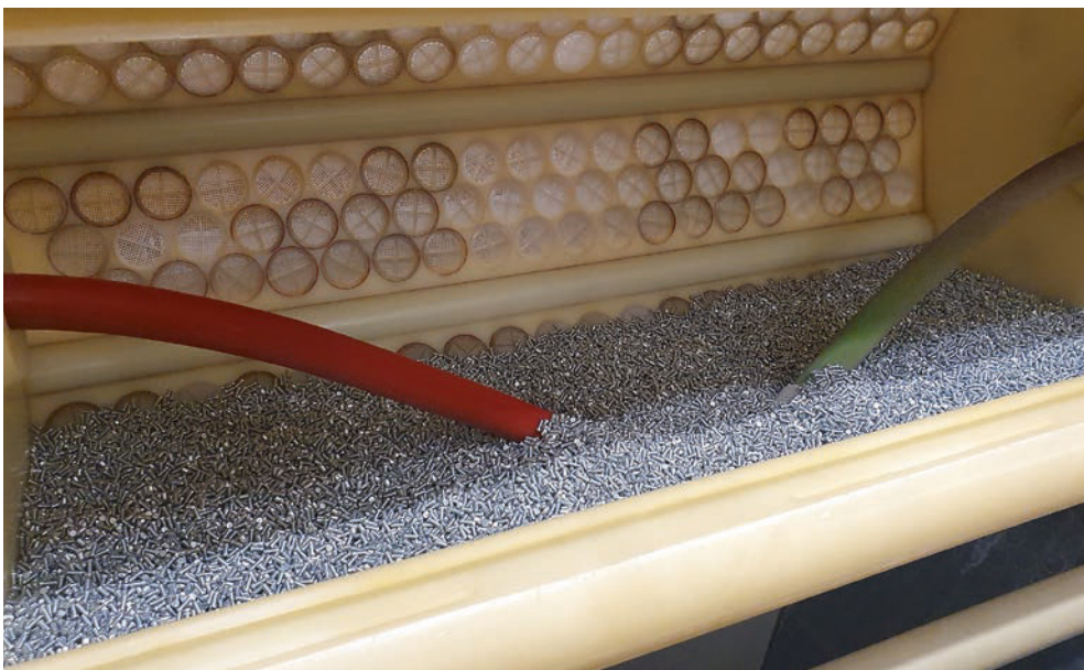
Bei einer Temperatur von 60 °C wird das Schüttgut der Trommel getrocknet.
