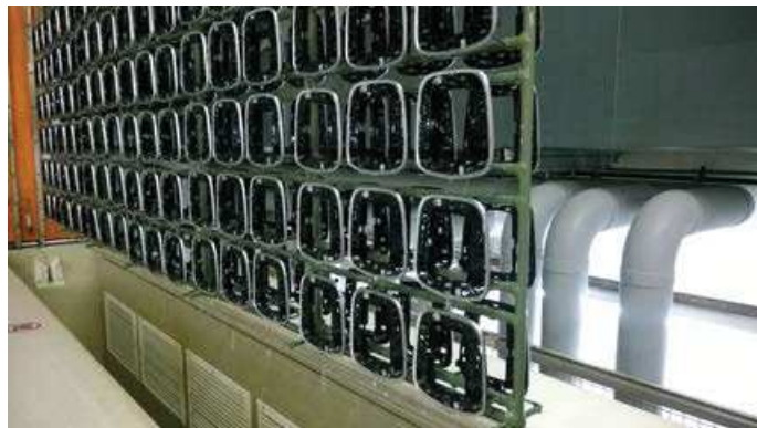
Abb. 1 und 2 zeigen Metall- und Kunststoffteile, die in Gestelltrocknern innerhalb der vorgegebenen Taktzeiten vollständig und schonend getrocknet werden
