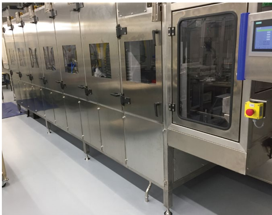
Bei 60 °C werden Schüttgüter und vereinzelt Elektrokomponenten unter Reinraumbedingungen vollständig getrocknet.
