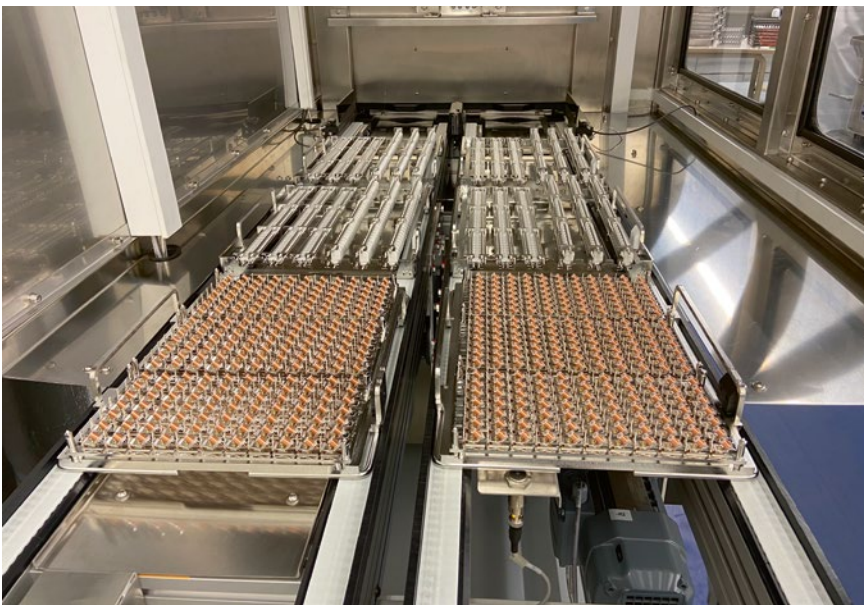
Eine Ampel gibt Signal. Alle acht Körbe werden per Knopfdruck nacheinander nach vorne transportiert, um eine bequeme Entnahme zu ermöglichen.
