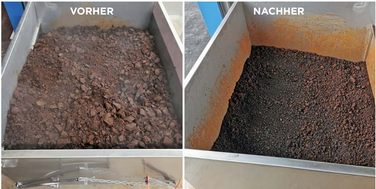
Abb. 2: Durch die Trocknung werden Volumen, Gewicht, vor allem aber die Entsorgungskosten des Schlammes erheblich reduziert
