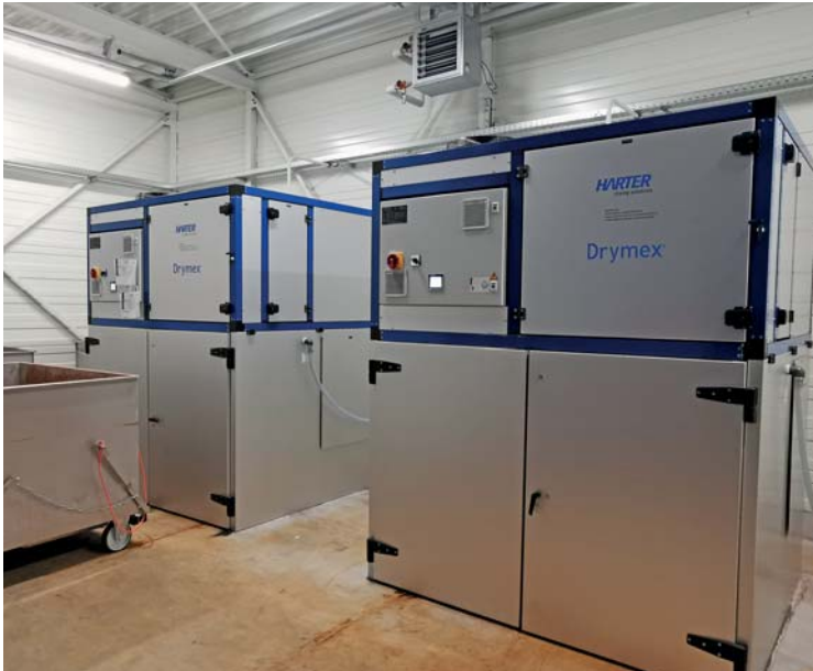
Abb. 3: Trockner Typ M5 mit je 2 Containern, die über ein Volumen von 1,5 m 3 verfügen
