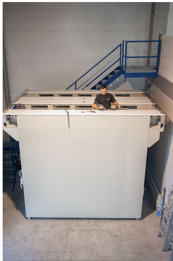
Im großformatigen Gestelltrockner lassen sich bis zu 6 m breite Aluminiumteile bei 50°C vollständig trocknen (im Bild: Beispiel mit 4,4 m Breite).
