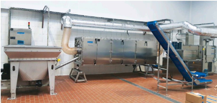
Die individuell konzipierte Anlage bei Maintal Konfitüren ist ein Durchlauf-Trommeltrockner mit Kühltunnel, Fördersystem, Dosierbunker und Staubabscheider. Endprodukt ist ein hochwertiges Bio-Wildrosenöl.
