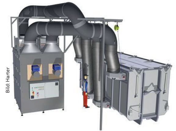
Trocknung im Abrollcontainer direkt unter der Kammerfilterpresse
