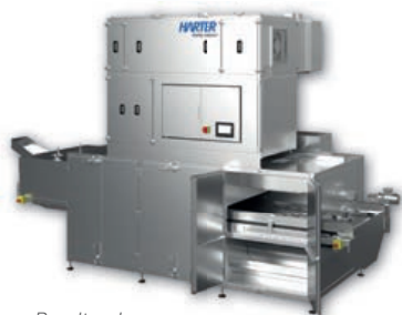
Bandtrockner, ideal zum Trocknen von Kräutern
