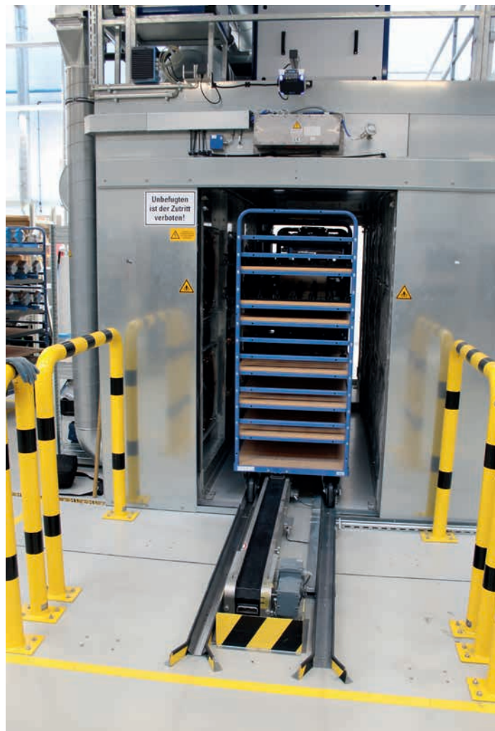
Die Hordenwagen werden in den Trockenraum gefördert.
