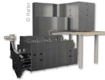
■ Abb. 3: Proteinfreies Weizenextrudat wird zu vegetarischen Bratlingen verarbeitet. Voraussetzung hierfür ist eine homogene Trocknung inklusive Entkeimungsschritt, die über einen Bandtrockner realisiert wird.
