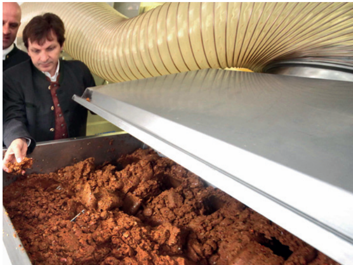
Pro Charge wird der Container mit 0,5 Kubikmetern Apfelmehl befüllt, der nach dem Trocknungsprozess einen Restfeuchtegehalt von fünf Prozent aufweist
