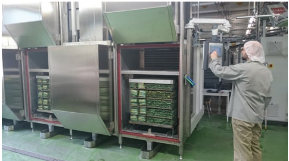
■ Abb. 3: In diesem Chargentrockner werden verpackte pasteurisierte Wurstsnacks bei 50°C getrocknet und anschließend auf 38°C gekühlt.
