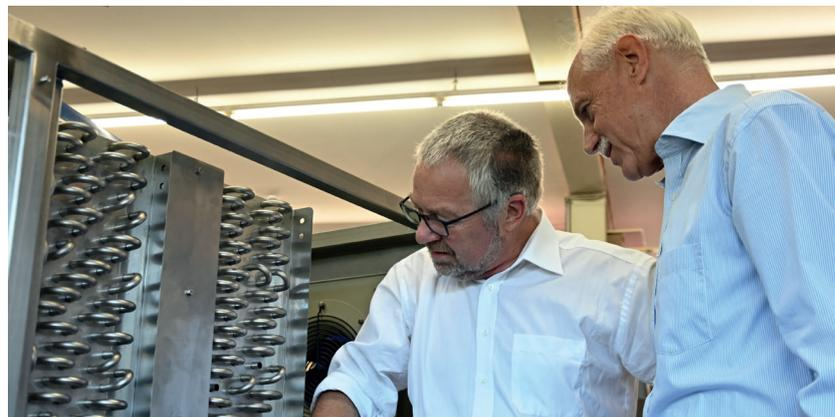
Das in den Trocknern verbaute und hocheffiziente Wärmetauscher-System erwärmt und kühlt die Prozessluft in zwei Stufen.
