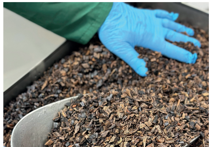
Vanillestücke mit einer Schütthöhe von ca. 150 mm werden bei 75 °C homogen getrocknet.
