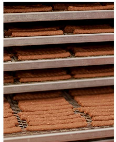
*Versuche bei 50 – 55 °C erbrachten Restfeuchten unter 10 %, was der gewünschten Konsistenz entsprach. Definierte Temperaturbereiche ermöglichen exakte Trockensubstanzgehalte und damit absolute Prozesssicherheit*
