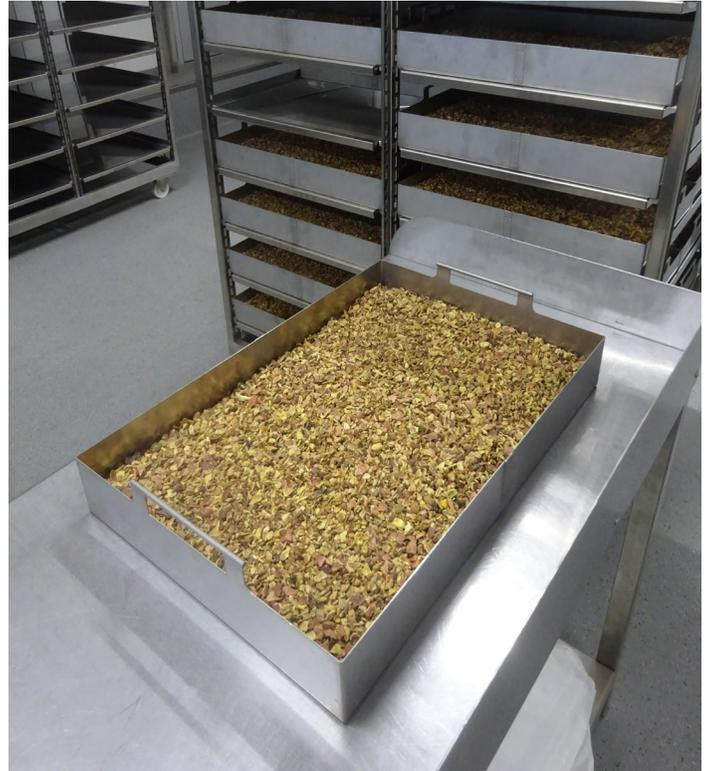
**Der in Edelstahl ausgeführte Hordentrockner bringt die Teezutaten innerhalb von sechs Stunden auf die gewünschte Restfeuchte von vier Prozent. Rechts: Die Kondensationstrocknung erfüllt höchste Ansprüche, hier bei der Verarbeitung von Granatapfelschalen.**
