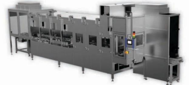
Kontinuierliche Trocknung in Körben – getaktet
