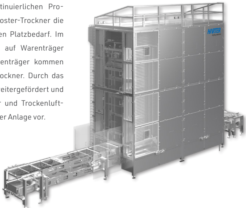
Paternoster-Trocknungsanlage mit vier Ebenen und vier Airgenex®-Entfeuchtungsmodulen
