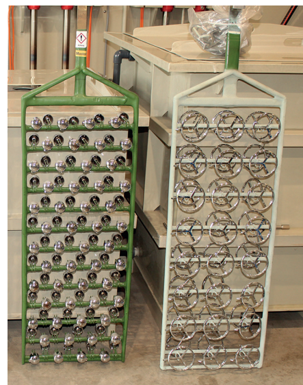
Bestückte Gestelle für Vorversuche zur Trocknung mittels Kondensationstechnik
