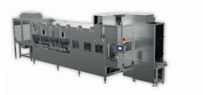
Kontinuierliche Trocknung in Körben – getaktet
