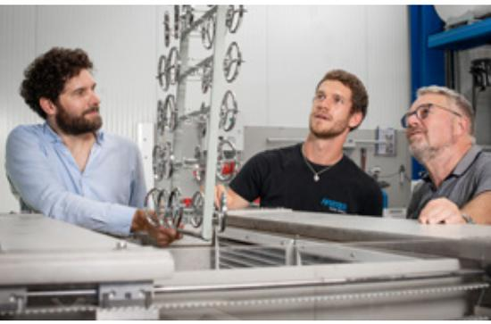
Versuchsreihen in unserem Technikum geben Aufschluss und Sicherheit. Wir testen Ihr Produkt hinsichtlich Temperatur, Zeit, Feuchte, Luftgeschwindigkeit und Luftvolumenstrom. Ebenso schauen wir auf die Luftführung im Trockner, denn sie ist ein entscheidender Faktor auf dem Weg zum Erfolg. Für all das verfügen wir über mehrere multifunktionelle Trockner, die unsere Techniker auf die jeweilige Anwendung anpassen.
