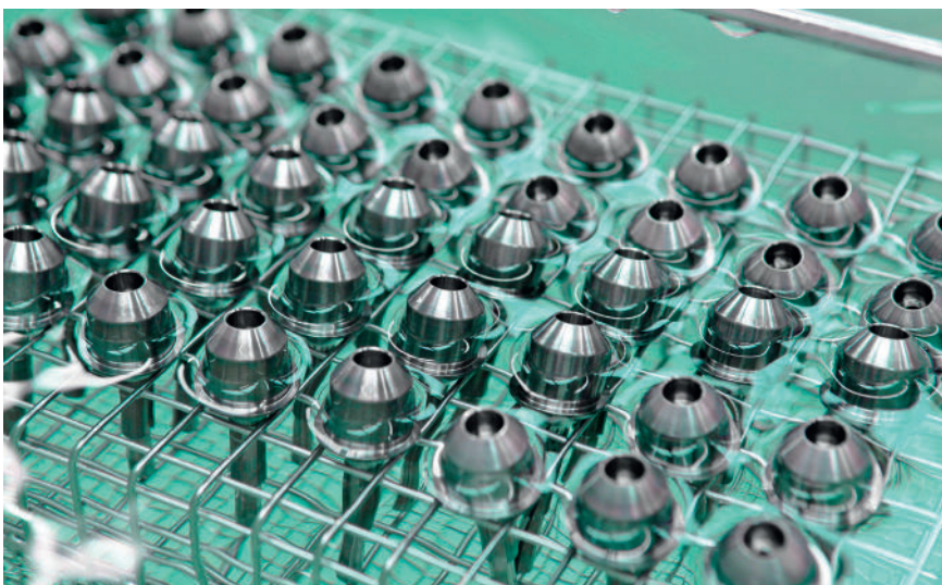
Eine bedarfsgerechte Reinigung und vollständige Trocknung sind Grundvoraussetzungen, um diese metallischen Komponenten für Implantate und Instrumente zu passivieren.
