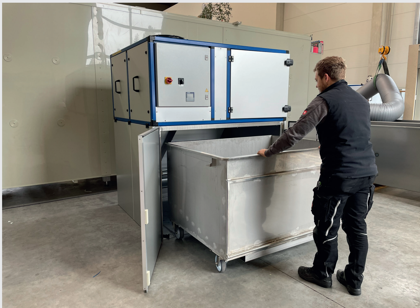
Bild 2 - Filtergepresster Schlamm wird auf eine Restfeuchte von ca. 15 % getrocknet. Die integrierte Wärmepumpe sorgt für eine energiesparende Trocknung und steigert die Einsparungen um ein Weiteres.
