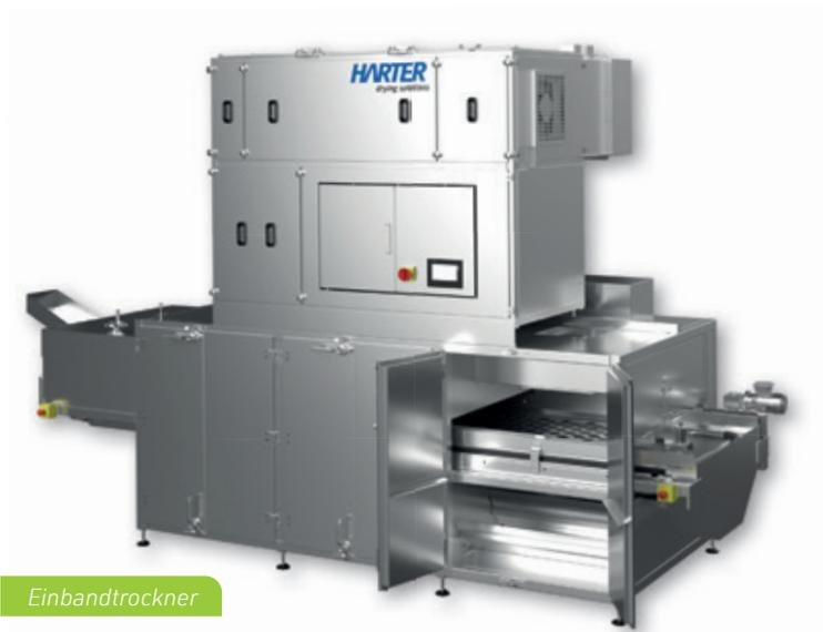
Bei sensiblen Produkten, die während der Trocknung nur minimal bewegt werden dürfen, sind unsere Einbandlösungen die richtige Wahl. Hierfür wird das zu trocknende Produkt auf ein durchluftbares Förderband aufgebracht und ohne weitere Produktbewegung durch die Trocknungskammer gefördert. Eine definierte Luftrichtung und Luftgeschwindigkeit, minimal erforderliche Trocknungstemperatur mit der entsprechenden Trocknungsdauer ergeben die Parameter für eine prozesssichere Anwendung.
