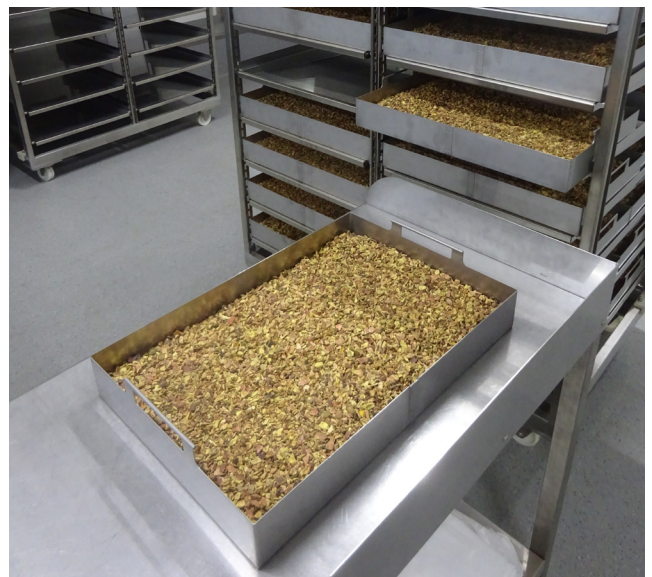
Abb. 1: Kräuter und Fruchtbestandteile zu wertvollen und aromatischen Teezutaten zu trocknen, gelingt mit dem flexiblen Hordentrockner. Die absolut homogene Trocknung findet bei 50 °C und ohne Abluft statt - in einem lufttechnisch geschlossenen System.
