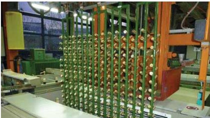
Abb. 1 und 2 zeigen Metall- und Kunststoffteile, die in Gestelltrocknern innerhalb der vorgegebenen Taktzeiten vollständig und schonend getrocknet werden
