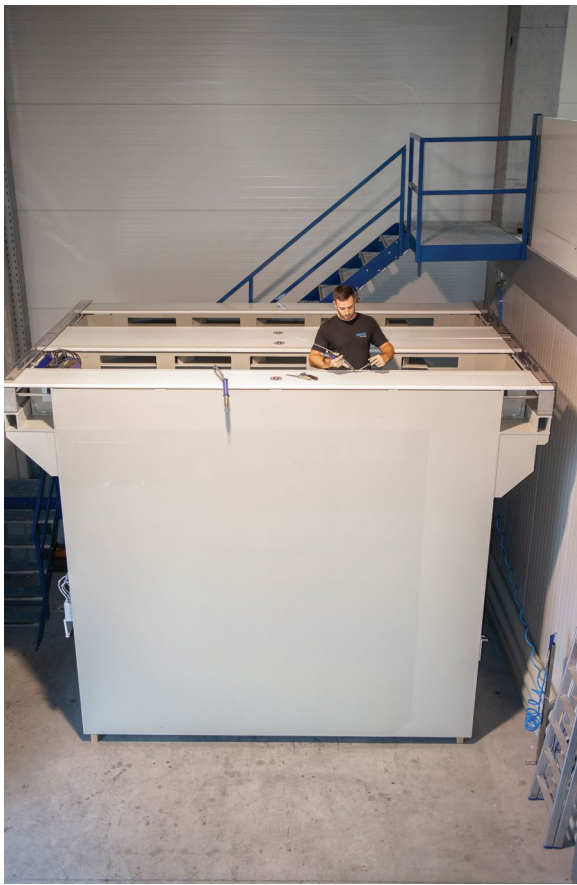
Im großformatigen Gestelltrockner lassen sich bis zu 6 m breite Aluminiumteile bei 50 °C vollständig trocknen (im Bild: Beispiel mit 4,4 m Breite).
