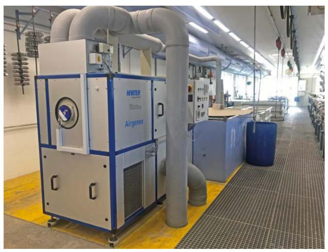
Das Entfeuchtungsmodul bereitet die erforderliche Prozessluft auf. Die integrierte Wärmepumpentechnik arbeitet so energieeffizient, dass sie staatlich gefördert wird.
