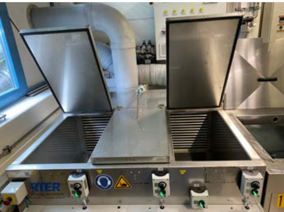
Die neue Trocknungskammer bei Jabil verfügt über drei Kammern für je zwei Körbe. Der Clou ist eine spezielle Luftführung. (Bild: Harter)
