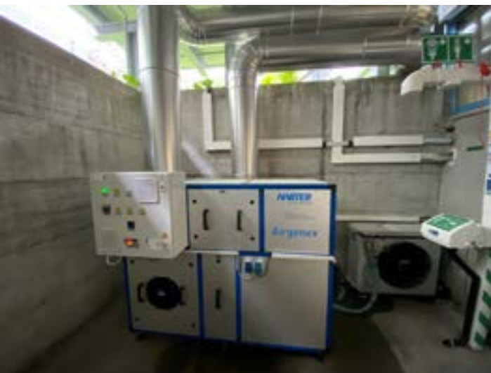
Das Entfeuchtungsmodul, das die Prozessluft aufbereitet, kann bei Platzmangel separat installiert werden. Durch eine isolierte Verrohrung ist es mit dem Trockner verbunden. (Bild: Harter)
