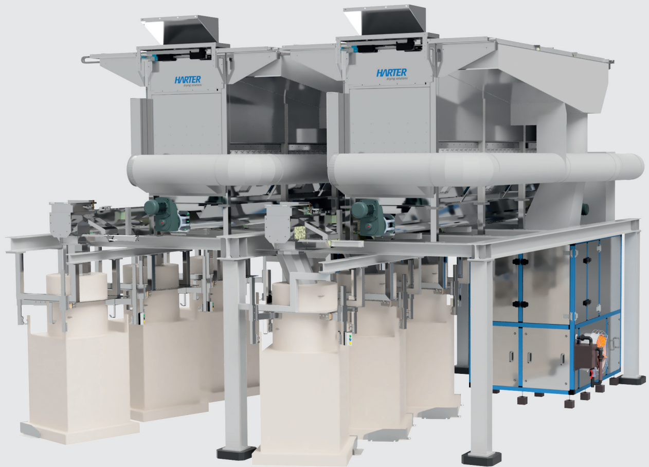
Bild 3 – Das vollautomatische Gesamtkonzept beinhaltet zwei Trocknungscontainer, zwei Wärmepumpenmodule, eine Förderschnecke und ein Transportband zu den Big Bags. Nach ca. 20 Stunden Trocknung bei 50 °C kommt der getrocknete Schlamm zum Recycling in den Hochofen.
