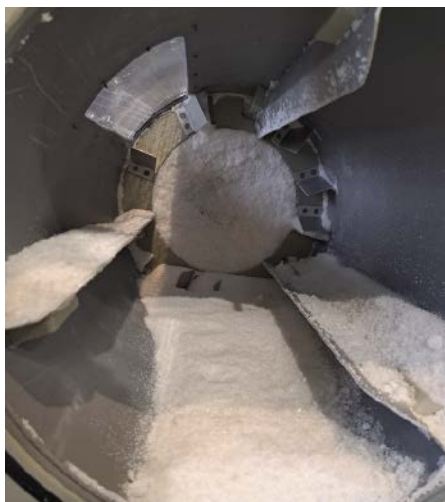
■ Abb. 2: Speisesalz wurde in einer Trommel mit leichter kontinuierlicher Drehung auf < 2 % Restfeuchte homogen getrocknet. Die Trocknungszeit hierfür betrug lediglich 40 Minuten.
