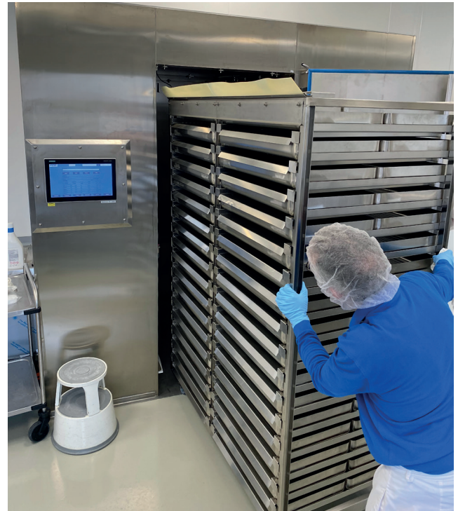
Abb. 1: Sehr unterschiedliche Granulate für die Tablettenherstellung werden bis zu einer klar definierten Restfeuchte homogen getrocknet. Die Schütthöhe beträgt maximal 60 mm.
