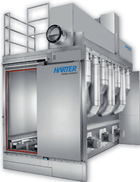
Abb. 4: In diesem Trockentunnel werden Infusionsbeutel bei 70 °C nach der Heißwasserberieselung getrocknet. Während bei anderen Projekten Kühl- und teilweise auch Temperierstufen integriert werden, war dies hier nicht erforderlich.
