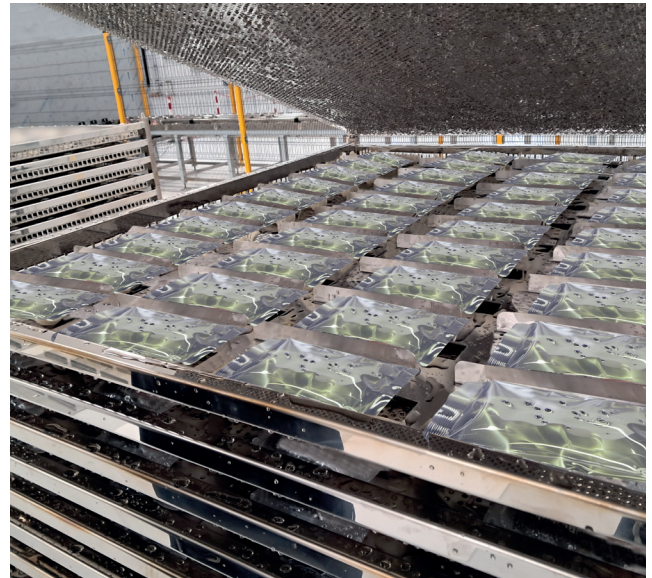
Abb. 5: Die Infusionsbeutel liegen dicht an dicht in 21 Lagen übereinander. Mit extrem trockener Luft und der richtigen Luftführung ist es möglich, alle Beutel gleichzeitig und vollständig zu trocknen.
