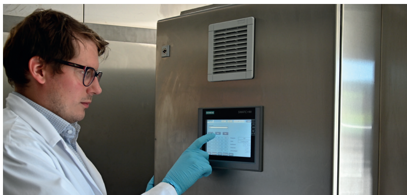
Bei anspruchsvollen Produkten können in der Steuerung fünf Phasen mit unterschiedlichen Parametern im jeweiligen Trocknungsprofil hinterlegt werden. (Bilder: Harter)
