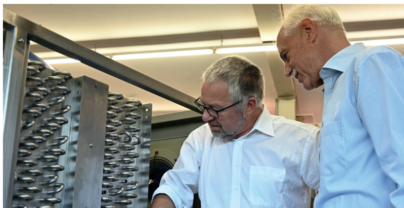
Das in den Trocknern verbaute und hocheffiziente Wärmetauscher-System erwärmt und kühlt die Prozessluft in zwei Stufen.
