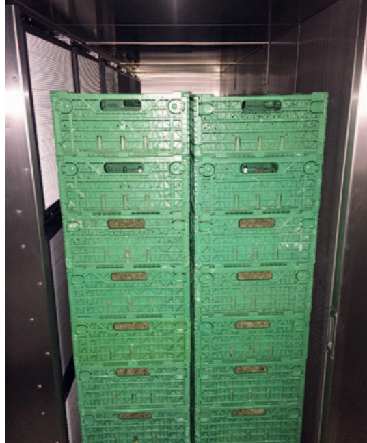
Zum Trocknen gestapelt: In jedes der drei Trockenmodule lassen sich vier Rollwagen mit je zehn Körben voll Hanfblüten einfahren.
