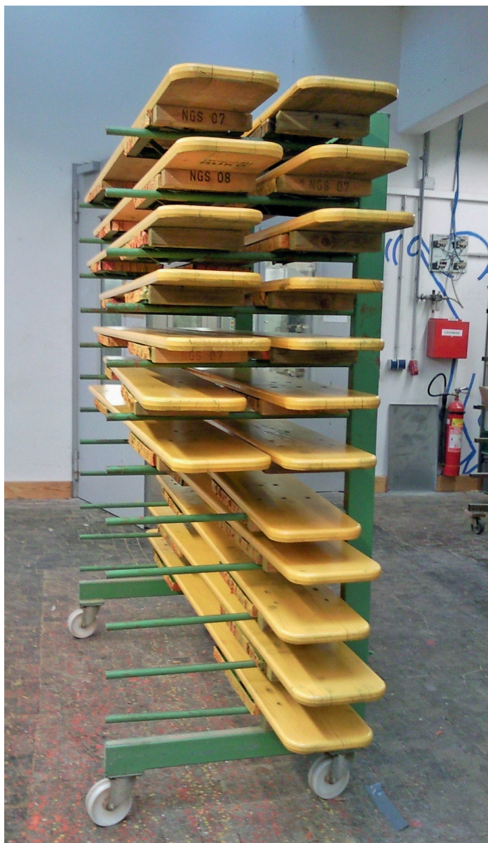
Auf Hordenwagen transportieren die Mitarbeiter die Bierbänke und -tische von der Lackierstraße zur Trocknung. Quelle (zwei Fotos): Harter
