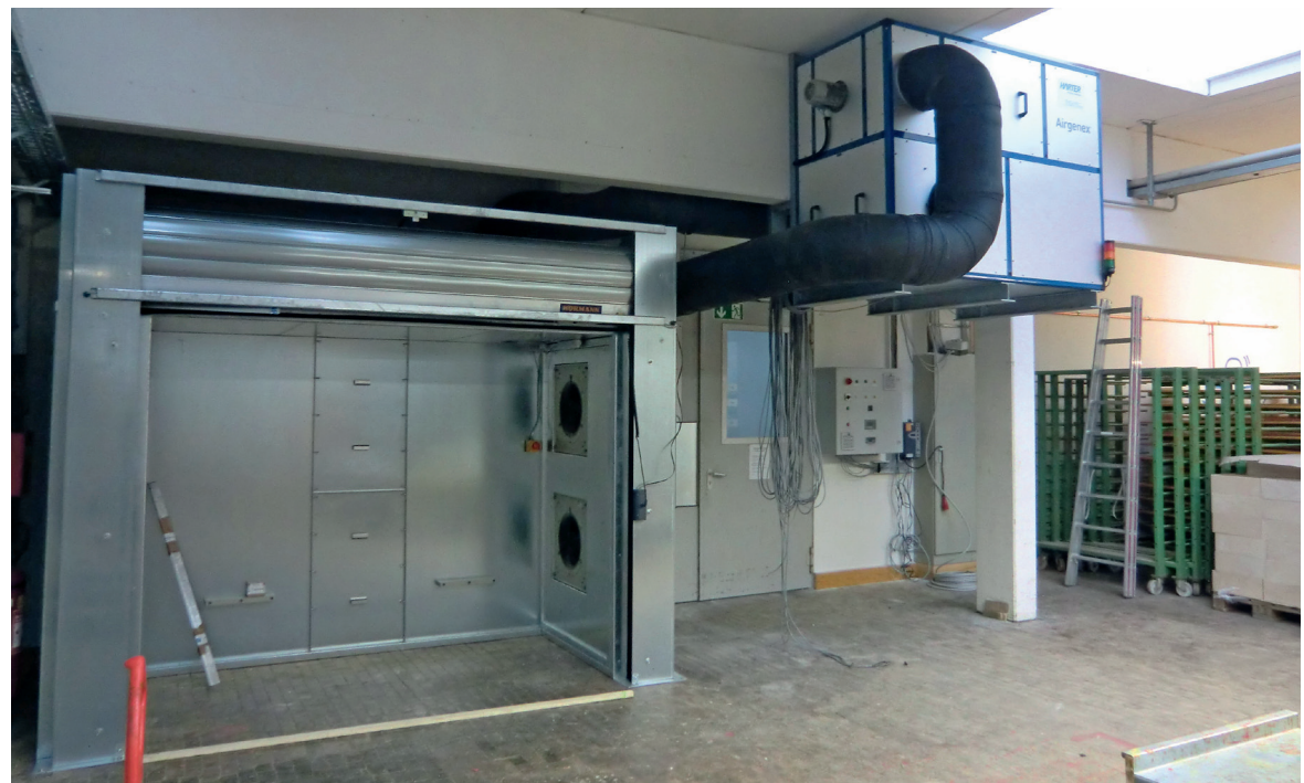
Im neuen Trockner kann jeweils ein Gestell unter definierten Bedingungen innerhalb von 20 min getrocknet werden.
