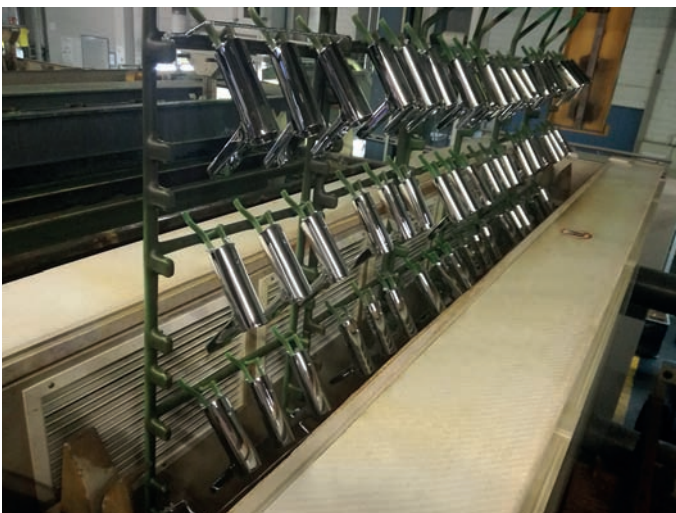
Armaturen mit anspruchsvollen Geometrien beim Einfahren in einen der drei Trockner
