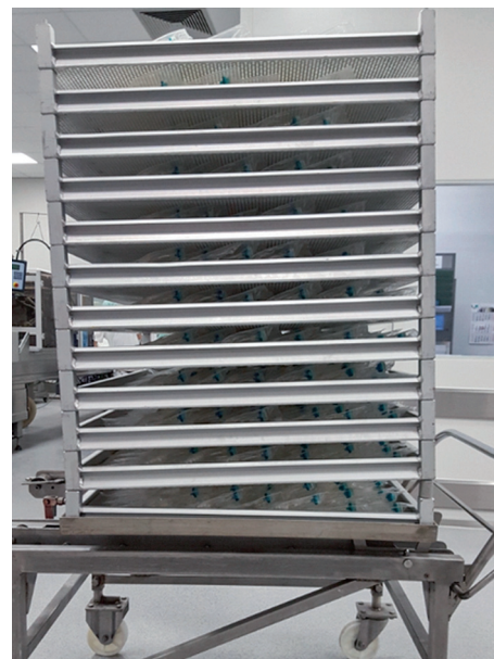
Bei den Versuchsreihen zeigte sich, dass neben der richtigen Luftführung ein Kippen der Bleche für eine erfolgreiche Trocknung erforderlich ist
