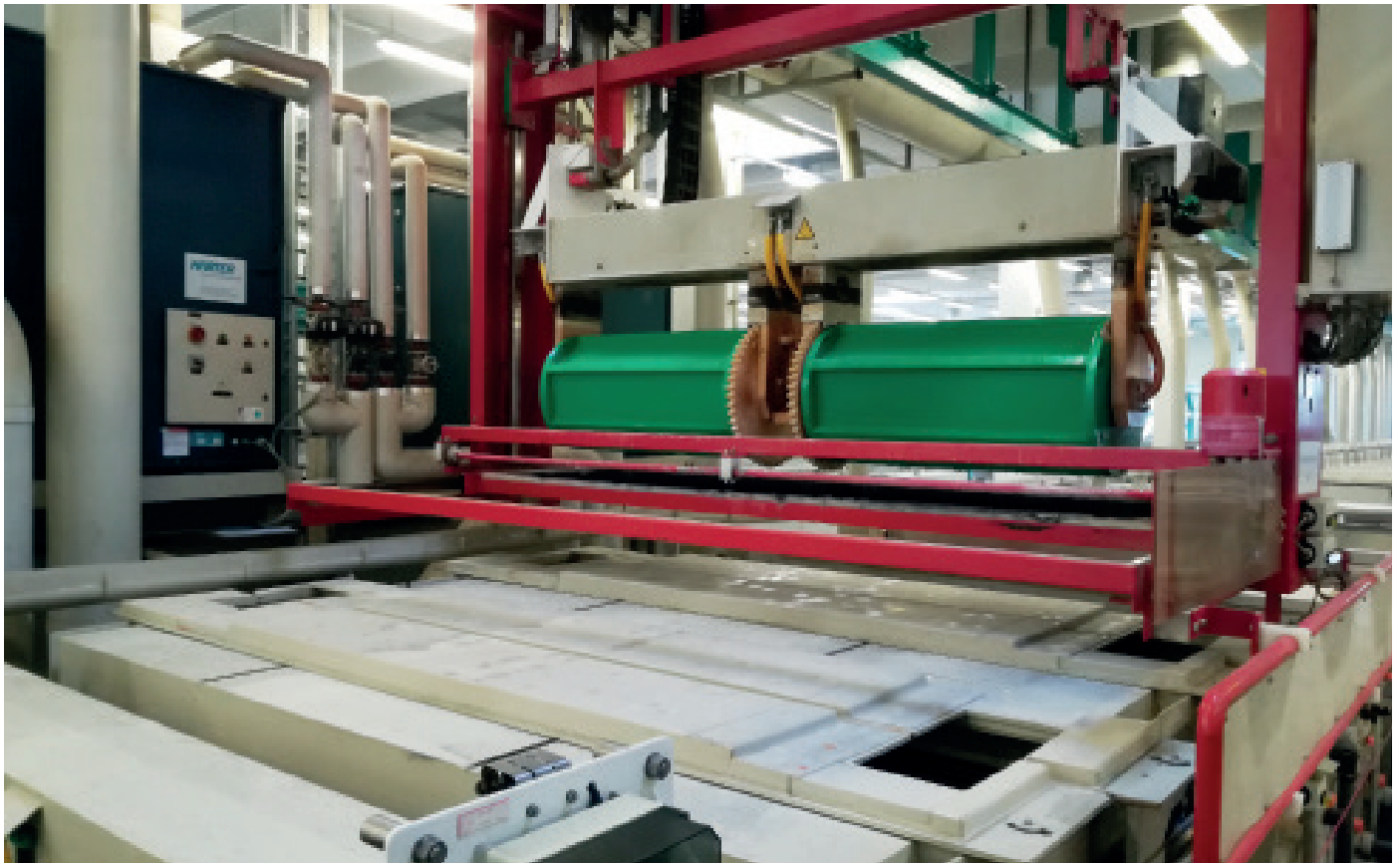
Bild 1: Im Trommeltrockner werden Schüttgüter mit minimaler Intervallbewegung bei Temperaturen von 70° C vollständig, schonend und zugleich energiesparend getrocknet
