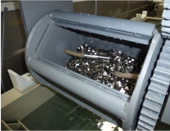
Maximal drei Minuten Trocknungszeit benötigen die unterschiedlichen Hartmetallteile, die auf vier Körbe verteilt werden.
