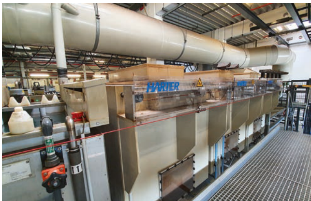
An drei Trocknungsstationen werden die Kleinteile schonend und homogen getrocknet.
