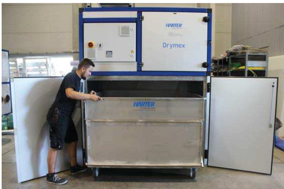
Abb. 5: Standard-Schlamm-trockner für 1000 kg pro Tag
