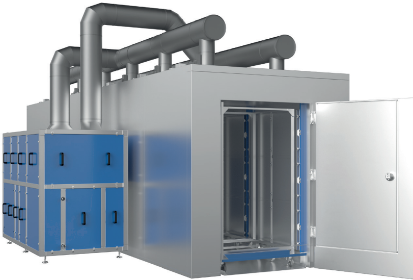
Der Hordentrockner mit 8 Kammern ist für die tägliche Charge von circa 1.500 kg Fleischbrät und die bereits vorhandenen Hordenwagen von Inter carne ausgelegt.
