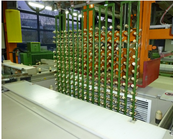
Teile von Türschlosssystemen werden bei Dormakaba innerhalb von zehn Minuten bei 70 Grad sicher und fleckenfrei getrocknet
