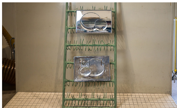
Während der Trocknungsversuche zeigte sich, dass für schöpfende Kunststoffplatten zusätzlich noch eine Abblasung erforderlich war
