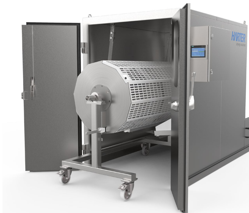
In Österreich wird der Apfeltrester in einem speziell entwickelten Trommeltrockner bei Temperaturen zwischen 40 und 50 °C schonend getrocknet.
